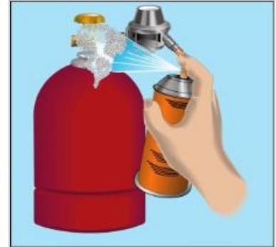
*Bild 5 Dichtheitsprüfung der Anschlussverbindung*
